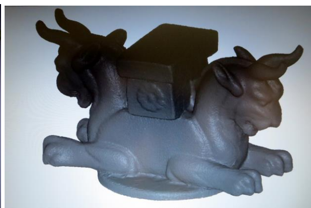
5b Objektoberfläche nach Lückenschließung
