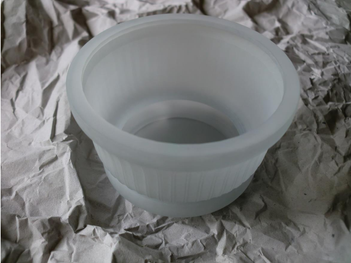
Abb.: 2 Gefertigtes Stereolithografie-Modell der Säulenbasis
