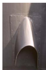
Abb.: 10. Genietete Bauteile der V-2
